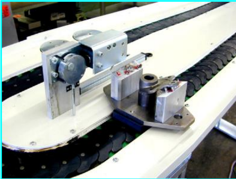
Ovalband, schmale Ausführung mit Spezialpalette für rechte und linke Werkstücke
