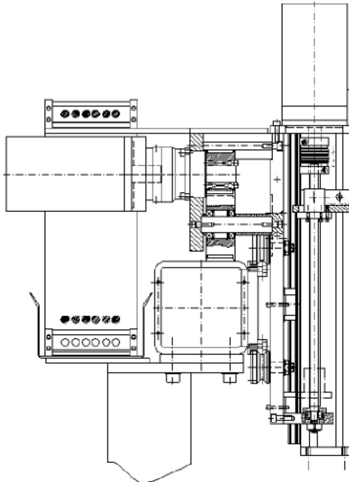
**Schnittdarstellung einer X - Achse der Baugröße 03 mit NC - Servomotor
